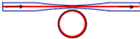
Рис. 11: Схема возбуждения микросферы с помощью растянутого волокна
