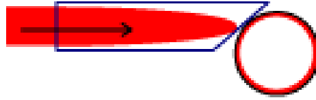
Рис. 13: Схема возбуждения микросферы с помощью градиентной линзы
